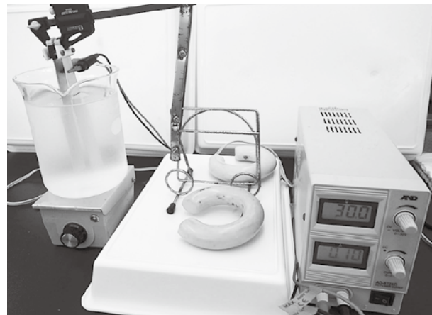
図 1 電気化学的処理試験装置
