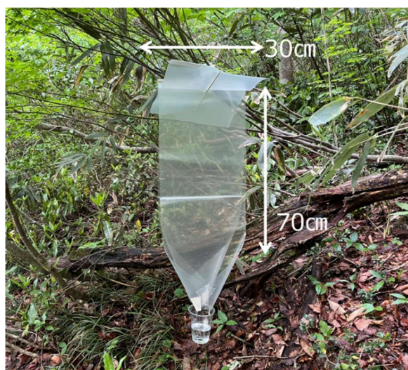
図4 吊下式 FIT とその設置状況
