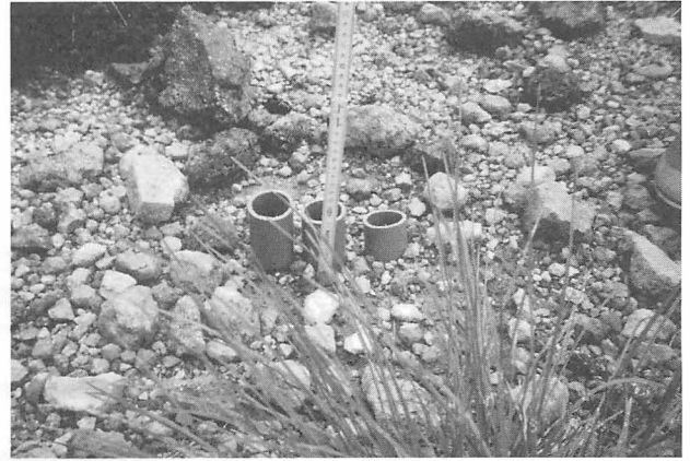
写真5 凍着上昇した塩ビ管（地点2） 左より埋設10cm深，20cm深，30cm深
