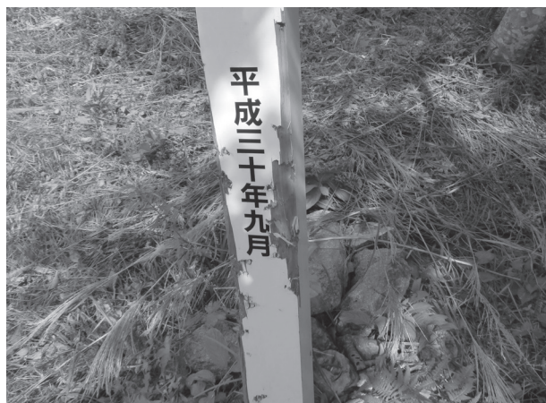
写真3 西山での塗装材新被害
