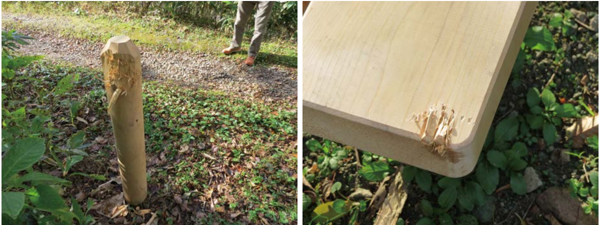
設置後間もない無垢材被害状況（H28 10月：医王山しがらくび付近）
