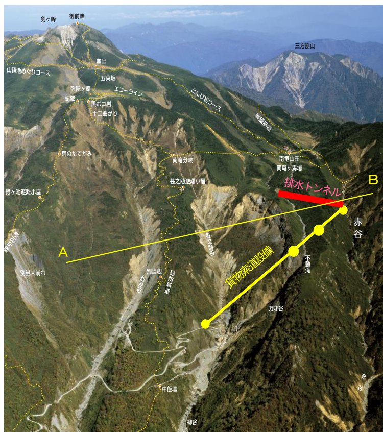
写真8 万才谷排水トンネルの位置
