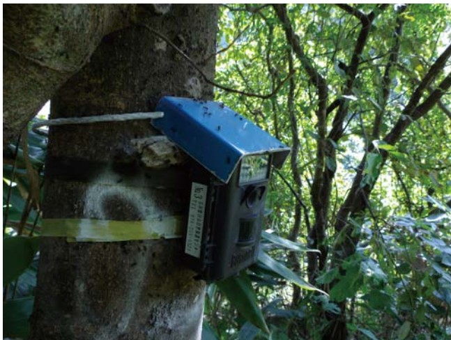
写真1 自動撮影カメラの設置状況 林道や けものみち 獣道沿いの立木にベルトで固定した。
