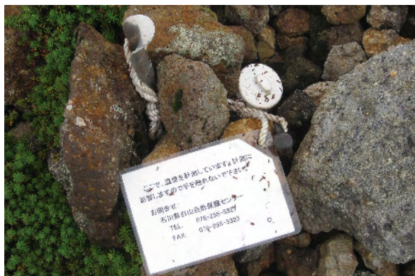
写真 1 現在、主に使用している温度センサー（ラベルの大きさは 7cm × 10cm）
