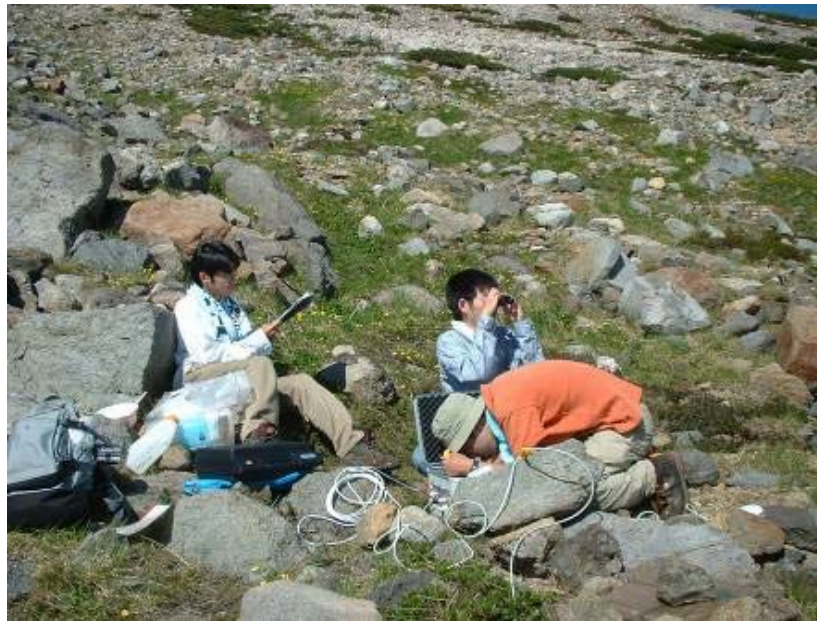
地震観測機器の設置
