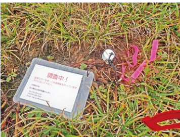
写真22 地温計の設置状況
