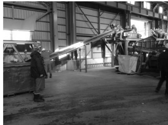
図 破碎後ホッパーへ投入
