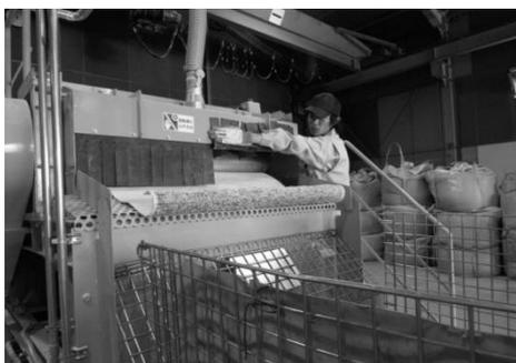
図 破碎機での破碎の様子
