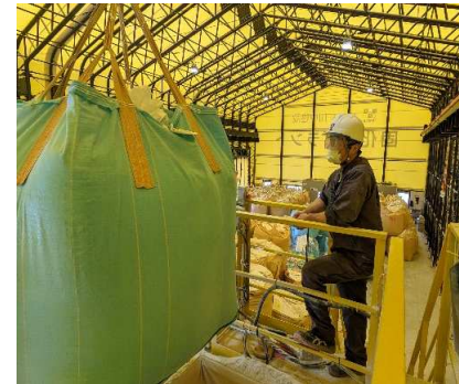
【二水石膏・ホッパー投入】
