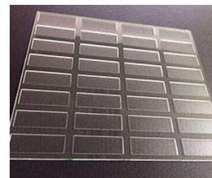
ウェットエッチングによる ガラスの掘り込み加工例 N社HPより
