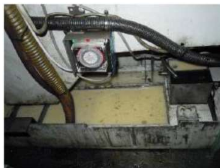
切削油の不純物を除去して延命化することによりリデュース
