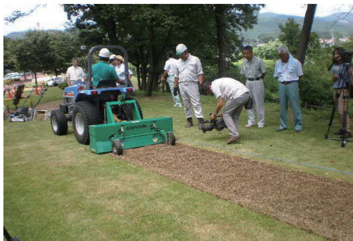
図-2-30：芝地の除染作業の例
