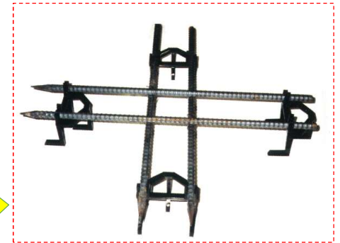
台座と鉄筋の固定状況
