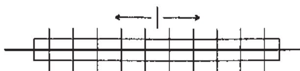
図 4 - 1 ボルト締付け順序
