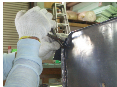
⑥天板の取付け 天板と背面板のハゼ締めを行っている状況。
