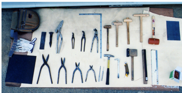
鉛葺工事で使用した道具
