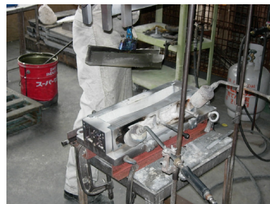
②軒平瓦鑄造状況2 鑄型から軒平瓦を取り出す。
