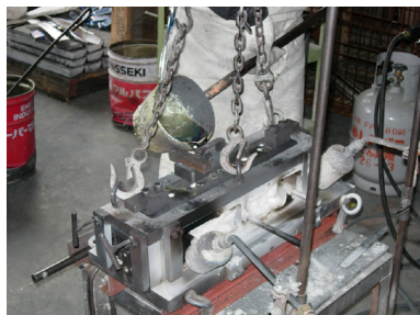
①軒平瓦鑄造状況1 鑄型に溶かした鉛を流し込む。
