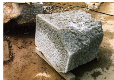
⑤石加工完了状況 中央部：ノミ切り、周囲：チョウナはつり
