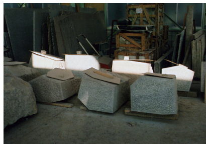
④石加工状況 石の上に置いてあるのが型板
