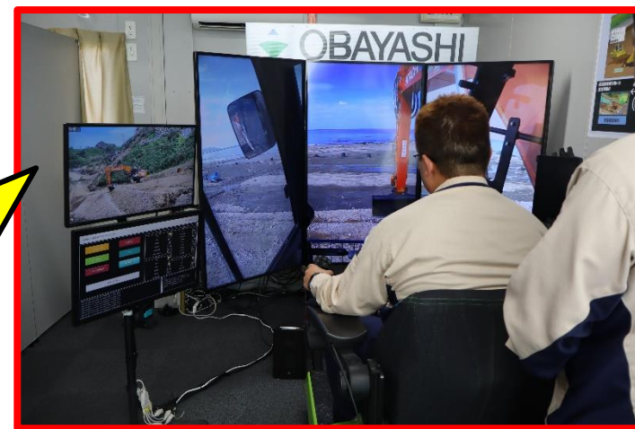
【重機を遠隔操作する作業員】
