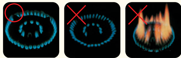
完全燃焼 空気過多 空気不足
