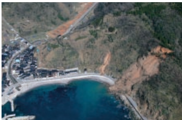
市道が大規模地すべりにより埋塞、集落裏山の斜面に亀裂が発生し、孤立した輪島市門前町深見地区=3月26日
