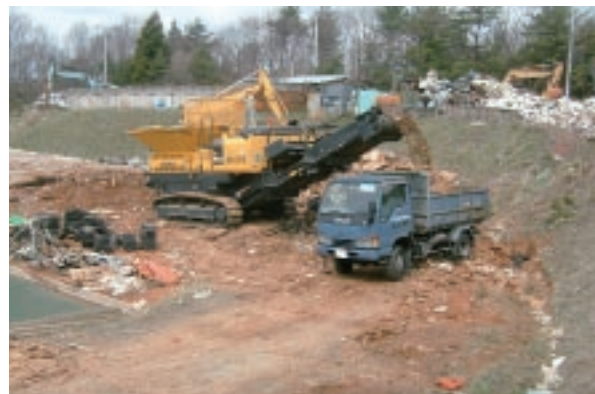
民間業者から無償提供を受けた災害廃棄物破碎機＝穴水町山中地内
